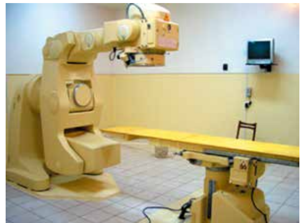
Рис. 1. Гамма-терапевтический ротационно-конвергентный компьютеризированный комплекс для реализации методов лучевой терапии «РОКУС-АМ»
